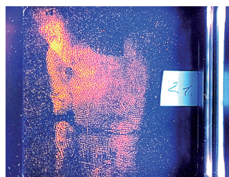
След пальца руки, обработанный люминесцентным порошком
